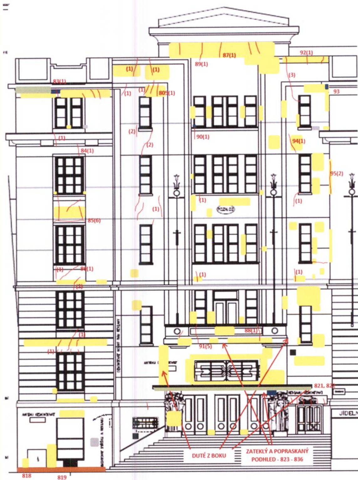
Schéma č. 8: Pasportizace poruch – část 3.
