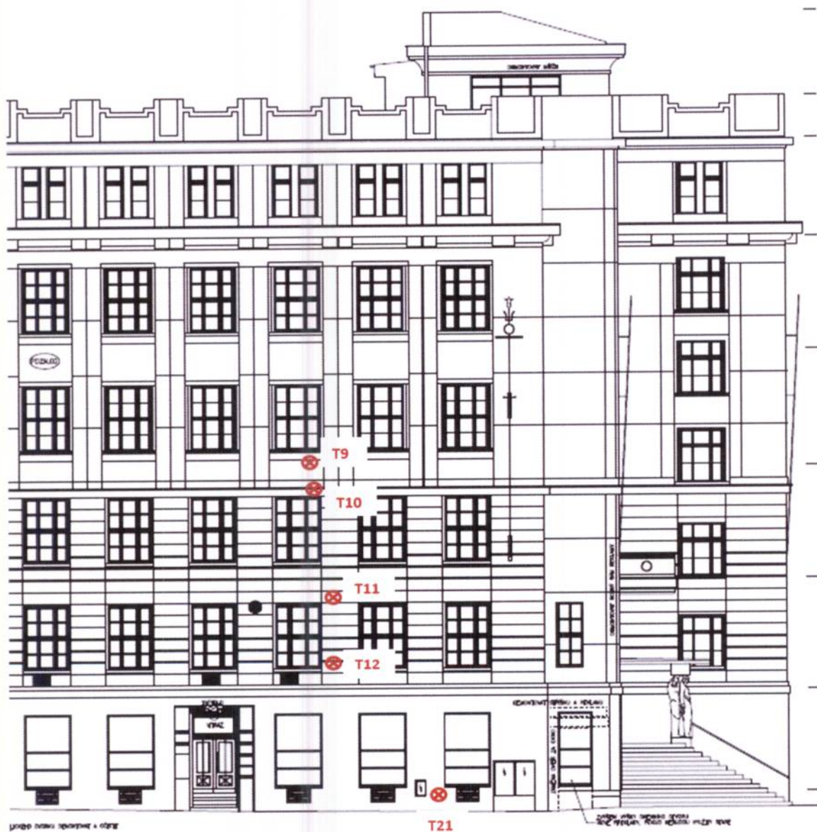
Schéma č. 10: Lokalizace stanovení soudržnosti omítek s podkladem – část 2.
